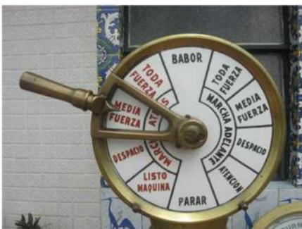
El problema viene cuando quieres parar y dar atrás. Entonces hay que esperar a que en la maquina reciban la orden, paren el motor, esperen a que la hélice se pare y después, poner en marcha el motor de nuevo, con las revoluciones avante. Una angustia continúa.
